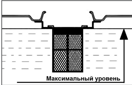
Рис. 8 Максимальный уровень топлива в топливном баке
