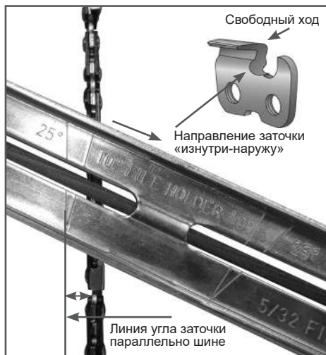
Рис. 16 Определение угла заточки
