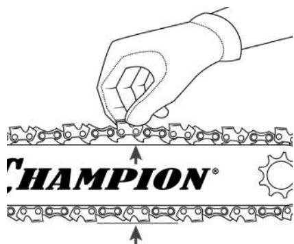
Рис. 4 Проверка натяжения цепи
